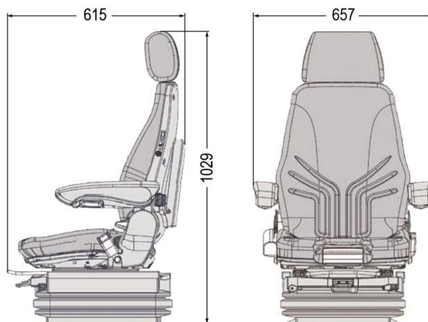
Ausgestattet mit automatischem Positionierssystem und einem einstellbaren Dämpfer verfügt der pneumatisch gefederte Actimo XL über sehr guten Schwingungskomfort. Durch die automatische Gewichtseinstellung entfällt das zeitaufwändige Einstellen des Sitzes auf das Gewicht des Fahrers, das ist ein großer Vorteil bei wechselnden Benutzern der Maschinen.
