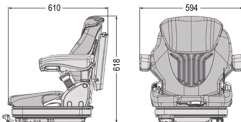
Die niedrigaufbauende mechanische Federung mit 80 mm Federweg ermöglicht durch die leicht zugängliche Ratschenfunktion den Fahrersitz optimal auf das Gewicht des Fahrers einzustellen. Das komfortable Sitzoberteil mit 470 mm Sitzpolsterbreite und mechanischer Lordosenstütze ermöglicht sicheres und ergonomisches Sitzen.
