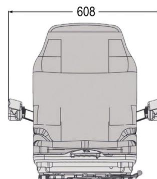
Die mechanische Federung mit reduziertem Federweg von 60 mm ermöglicht effizienten Schwingungsabbau selbst in kleinsten Fahrerkabinen. Die Ausstattung des Oberteils bietet Komfort ab der ersten Minute und konzentriert sich auf die wesentlichen Einstellungsmöglichkeiten, wie die mechanische Lordosenstütze und die mechanische Gewichtseinstellung.
